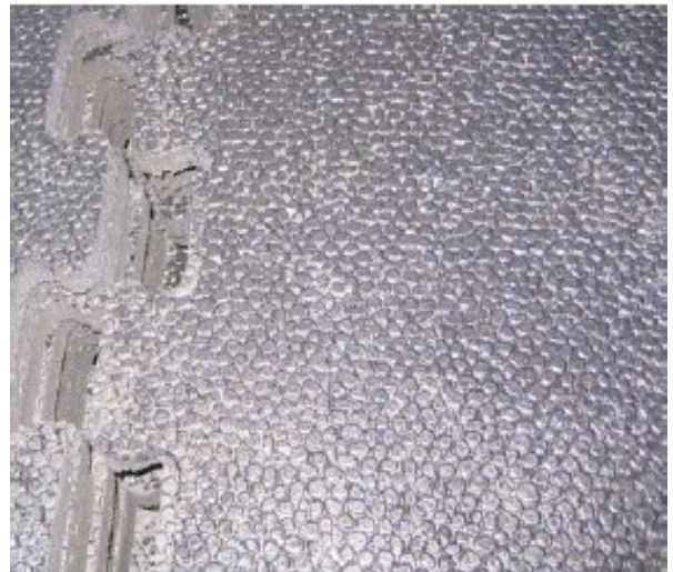
Overside med "hammerslag-profil"
